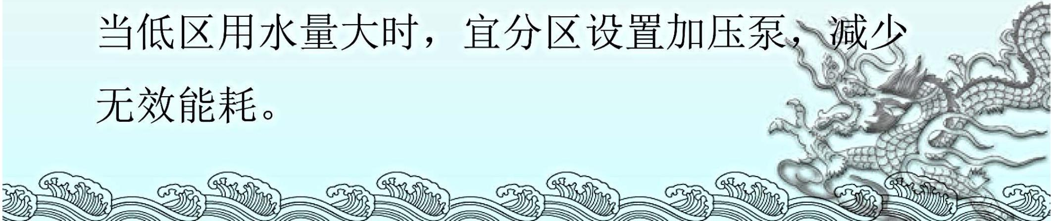
**6.2.4** 变频调速泵组应根据用水量和用水的均匀性等因素合理搭配水泵及调节设施，保证水泵在高效区运行。
